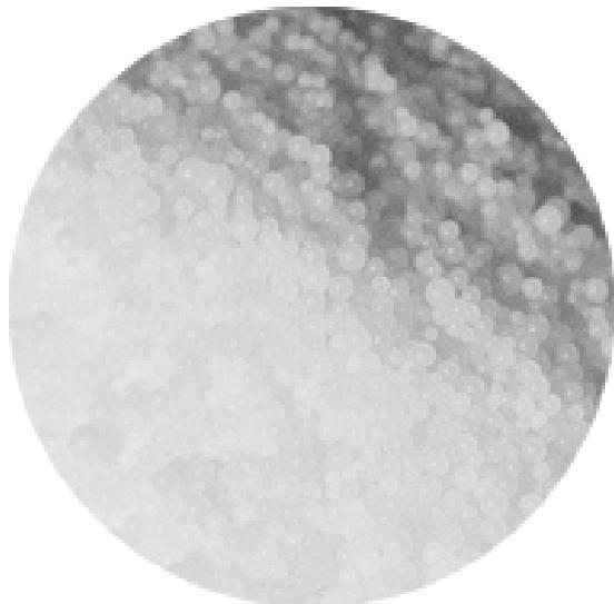
Функциональная добавка в битум на основе полимерного воска для структурной модификации битума.
